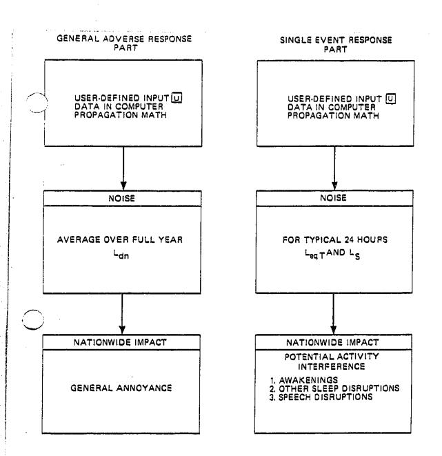
FIGURE F-1 THE NATIONAL ROADWAY TRAFFIC NOISE EXPOSURE MODEL
